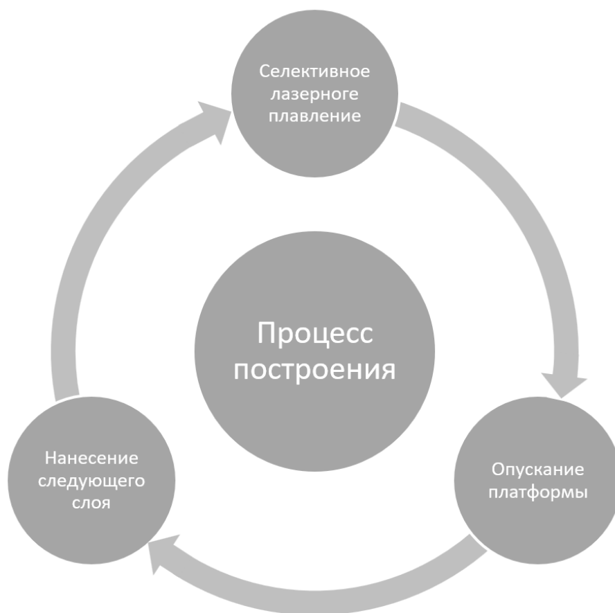
Рисунок 3 - Основной процесс производства имплантата
