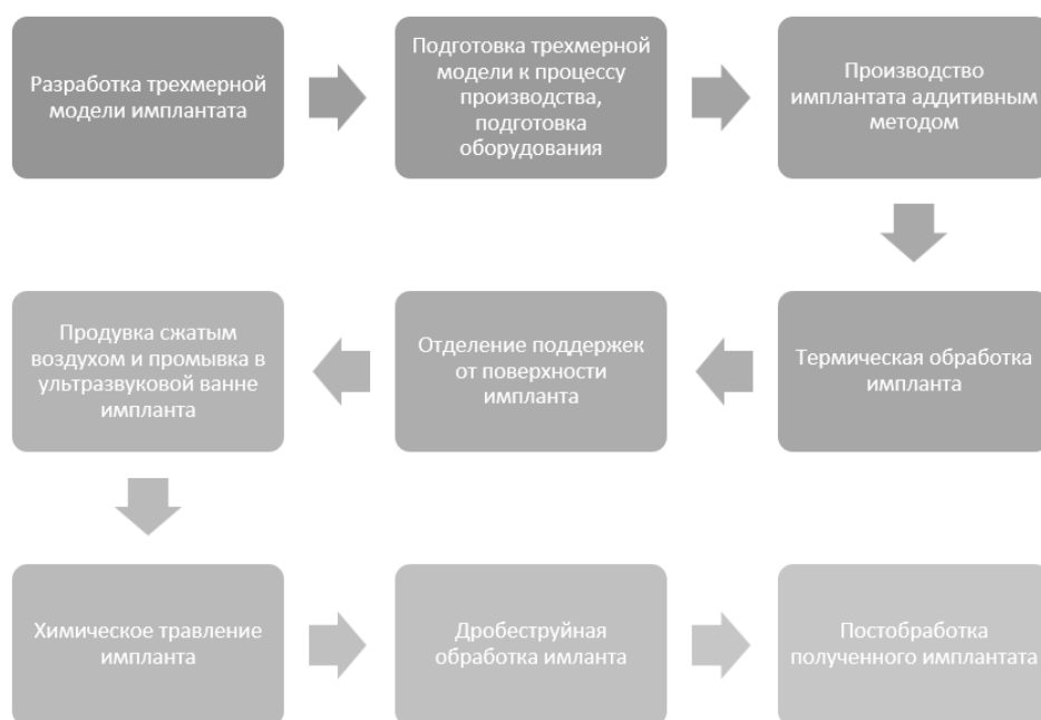
Рисунок 1 - Этапы производства имплантата с использованием аддитивных технологий
